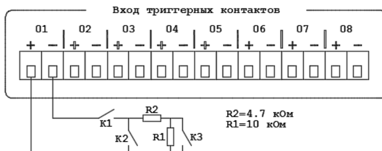
Рис. 2.3. Схема подключения внешних сигналов управления к LPA-DUO с контролем целостности
